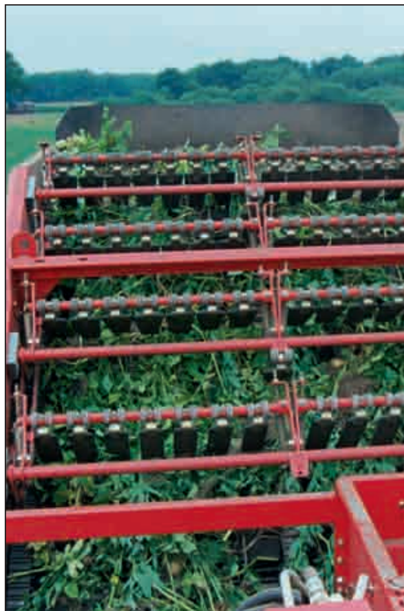
Щадящая обработка продукта: транспортер для отделения крупной ботвы с мягкими скребками из полиуретана (расст. 210 мм, 280 мм)
