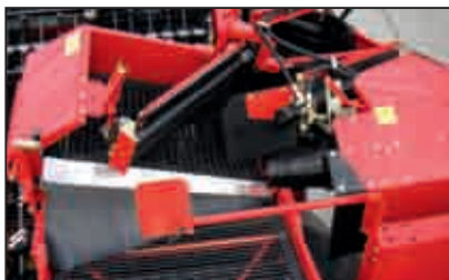
Тип NB с 3-м игольчатым транспортером и 3-м счищающим вальцом – для ещё большей производительности на почвах с низким содержанием примесей.
