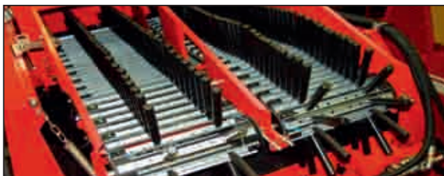
Тип UB: наилучшие результаты – на почвах с большим содержанием комков и небольшим содержанием камней
